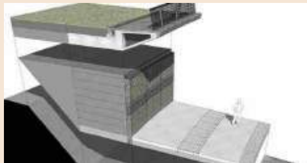
Mausoleo di Augusto insula sistema costruttivo
